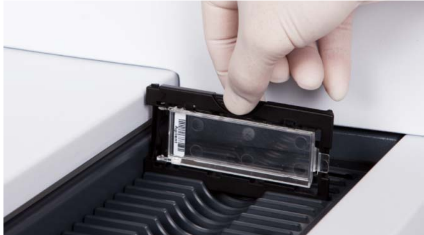
Obrázek 44 Vložení čipu do zásobníku
