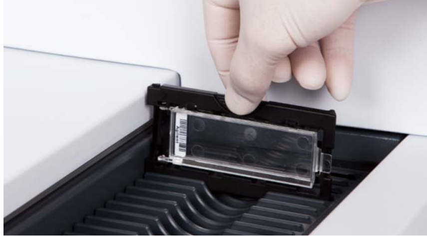
Figura 44 Introducerea suportului pentru lame în casetă
