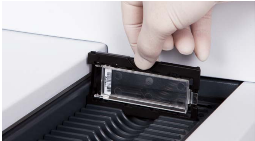
Figure 44 Insertion du porte-diapositive dans le panier
