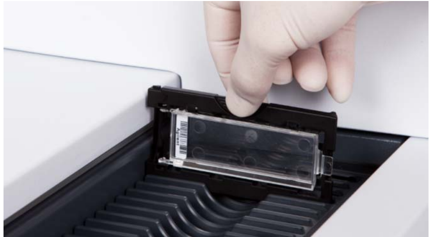
Abbildung 44 Einsetzen des Objektträgerhalters in die Kassette
