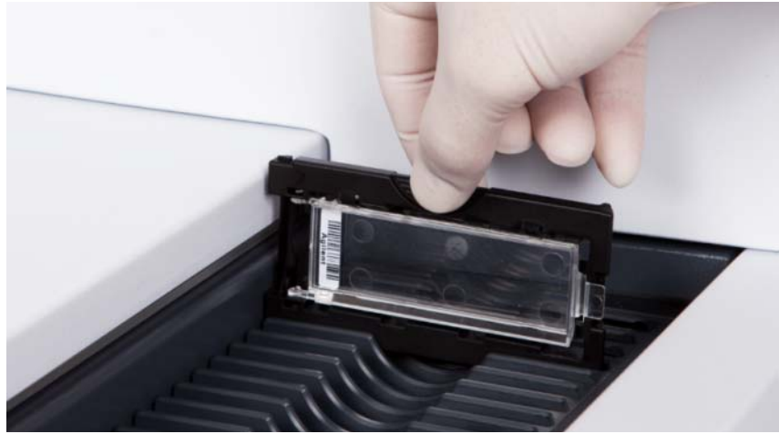
Figur 44 Sätta i objektglashållaren i kassetten
