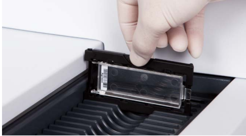
Εικόνα 44 Τοποθέτηση θήκης πλακιδίου στην κασέτα
