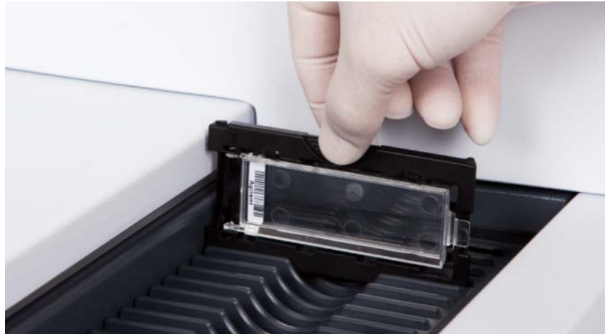
slika 44 Umetanje držača slajdova u kasetu
