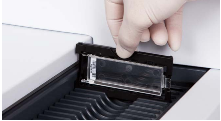
Şekil 44 Slayt tutucunun kasete yerleştirilmesi
