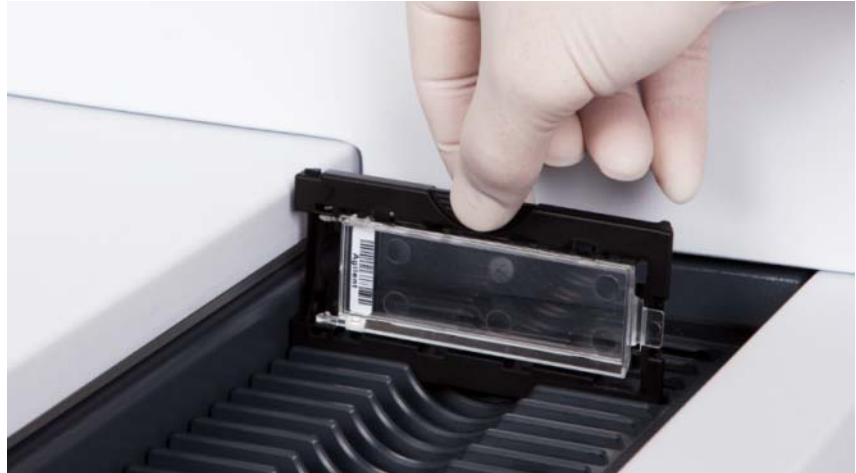
Slika 44 Vstavljanje držala objektnih stekel v kaseto
